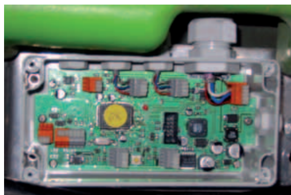
Le boîtier APU sur le pulvérisateur
